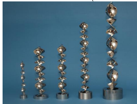
Aus Rundmaterial an einem Stück gefertigt, keine Schweissstellen . Beliebiger Durchmesser und L/D der ME möglich
