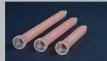
Der GFX-10-Einwegmischer ist ein faltbarer Einwegmischer mit einem Innendurchmesser von 10 mm in Standardrohren mit 6, 9 oder 12 Mischelementen. Mischelemente sind auch lose für den Einbau in entsprechenden Stahlrohre mit Innendurchmesser von 12 mm verfügbar. Dieser X-Gitter-Mischertyp eignet sich optimal für schwierig zu mischende Harz/Härter-Systeme, wie z. B. 2-K-Lacke, PU, Kleb- und Dichtstoffe sowie für Medien mit grossen Viskositätsunterschieden.
