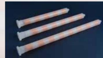
Der GFX-21 Einwegmischer ist mit grossen Durchmessern von 21 mm erhältlich. Standardrohre sind erhältlich mit 9, 12 oder 15 Mischelementen. Diese grossen Rohre sind flexibel über Flansche oder mittels Rohrgewinden am Eintritt (3/4") sowie am Austritt (1/2") anschliessbar.
