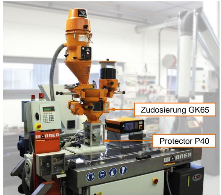
Thermogranulator als z.B. Compound-Anlage mit gravimetrischer Zudosierung GK65 von Koch-Technik und Protector P40 Metallsuche von Sesotec
