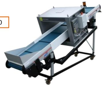
GL-Föba mit Metall-Detektion
