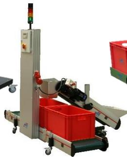
GL-EM 010 als Linearpuffer mit S7 Steuerung
