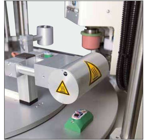
Komponente Infrarottrocknung – verkürzt die Trockenzeit der Tampondruckfarbe
