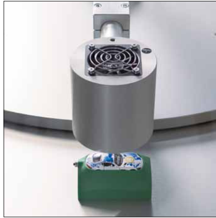
Komponente Zwischentrocknung – leichtes Antrocknen der Tampondruckfarbe für schnellere Weiterbedruckung
