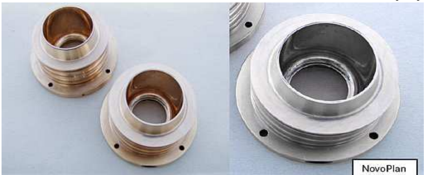
Bild 4: Werkzeugeinsatz aus Hovadur® K350, links unbeschichtet, rechts beschichtet (HCN)
