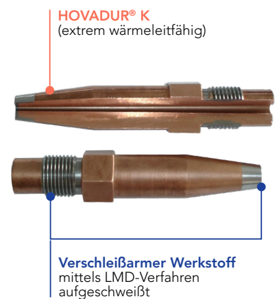
Einsatz des LMD-Verfahrens am Beispiel einer Maschinendüse aus wärmeleitfähiger HOVADUR® K-Legierung
