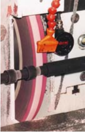
Bild 3: Einstich-Schleifen von Silikonwalzen. Zum Temperatur- und Spannungsabbau sind zwischen den Schleifgängen Pausen erforderlich.
