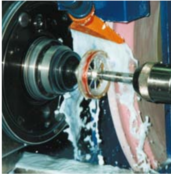
Bild 1: Nass-Schleifen einer Transportrolle mit Polyurethan-Ummantelung, die auf ein Aluminium-Speichenrad gegossen wurde. Es wird eine V-Kontur (0,02 mm Toleranz) geschliffen.
