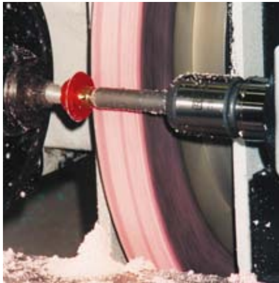
Bild 2: Trocken-Schleifen einer Polyurethanrolle. Es wird eine Schrägkontur mit 0,05 mm Winkelgenauigkeit erzeugt.
