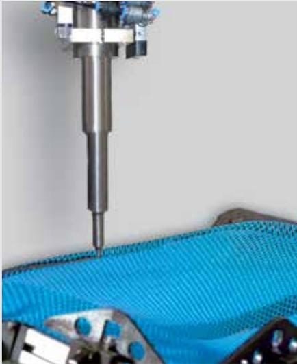
← Robotergeführtes Schwingersystem mit Schneidsonotrode
