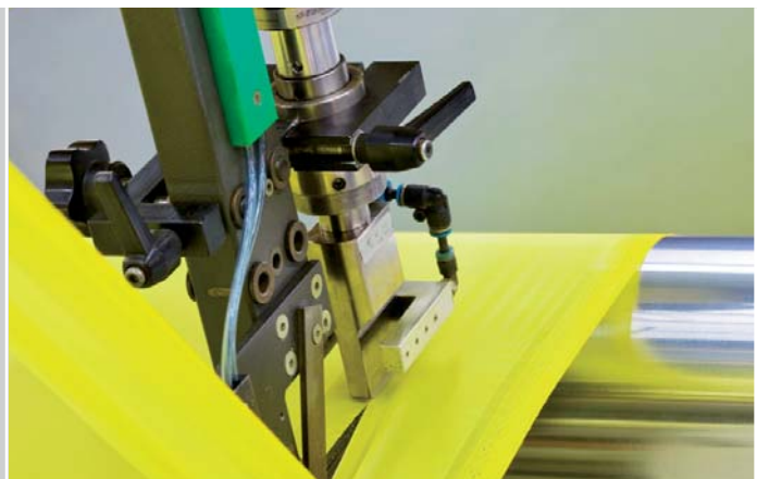
2 Textiles Ultraschall-Schweissen von Taschenfedern.
