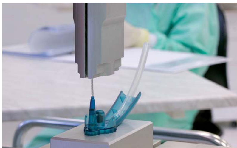
Verschweissung eines Thrombektomie-Systems in Reinraum-Umgebung
