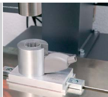
Verschweissung eines Thrombektomie-Systems in Reinraum-Umgebung
