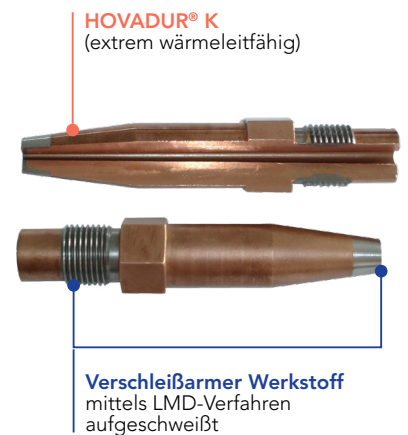
Einsatz des LMD-Verfahrens am Beispiel einer Maschinendüse aus wärmeleitfähiger HOVADUR® K-Legierung
