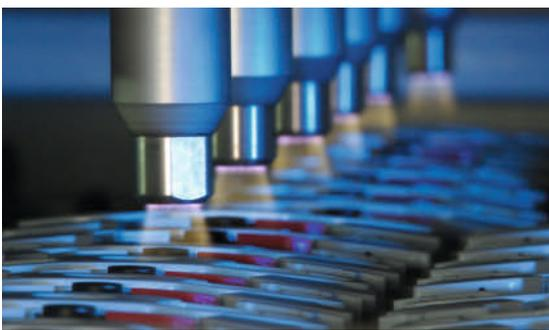
**Bild 4.** Sechs Rotations-Plasmadüsen arbeiten inline rund um die Uhr. Sie reinigen und aktivieren in einer Funktion 180000 Sichtteile aus PC und (PC+ABS)-Blend pro Woche
