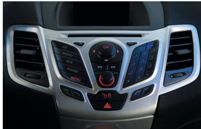
**Bild 1. Das ICP-Bedienfeld (Integrated Control Panels) ist das Herzstück einer Instrumententafel. Für ein makelloses Lackbild und eine über Jahre andauernde Haftung werden die Kunststoffasten vor der Lackierung mit atmosphärischem Plasma vorbehandelt**
