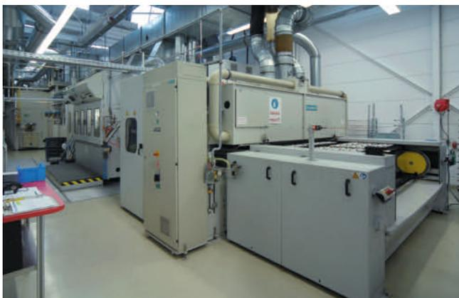
**Bild 2. Das Openair-Plasmasystem (3. Einheit von vorne) beansprucht nur einen Meter der insgesamt 25 m langen Lackierstraße**
