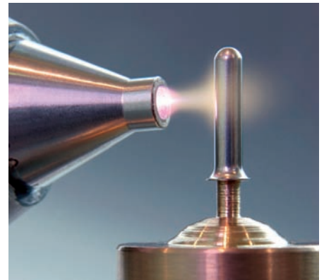
Abb. 6: Medizin-Mehrkomponententechnik: Das plasmapbehandelte Metallinsert wird anschließend im Spritzgussprozess mit Kunststoff umspritzt. (Foto: Gira)
