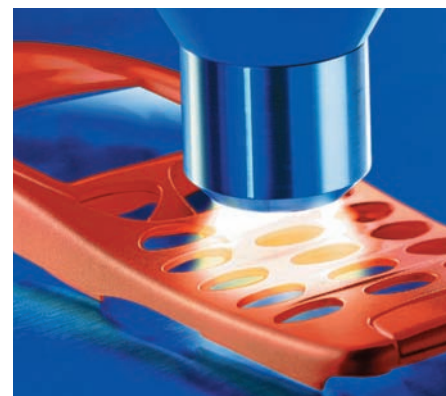
Abb. 1: Für ein makelloses Erscheinungsbild werden hochwertige Handygehäuse vor dem Lackieren mit Plasma vorbehandelt. Die rotierende Openair-Düse erreicht Wirkbreiten bis 130 mm. (Foto: Plasmatrete)
