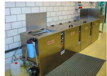
3-Kammer Handanlage für das Reinigen, Spülen, Konservieren und Abblasen von kleineren Formen
